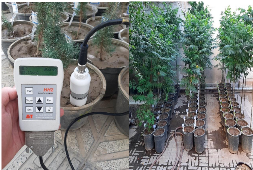
شکل ۲. تصاویری از لایسیمترها و نهال‌های کشت شده و پایش رطوبت در آن‌ها با استفاده از دستگاه رطوبت‌سنج HH2 Fig 2. Images of lysimeters and cultivated seedlings and moisture monitoring in them using a TDR moisture meter.
